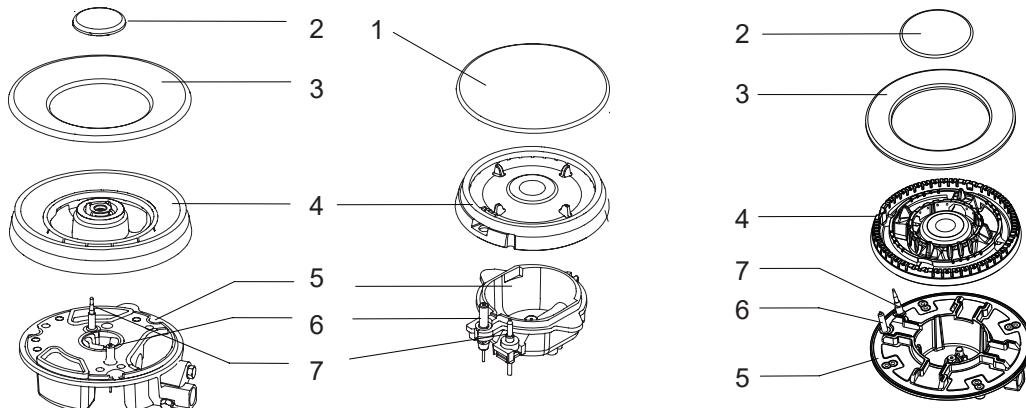
1. Postavite raspršivač plamena ( 4 ) na bazu plamenika ( 5 ) tako da upaljač i sklop za kontrolu plamena nasjednu u odgovarajuće otvore na raspršivaču plamena.
