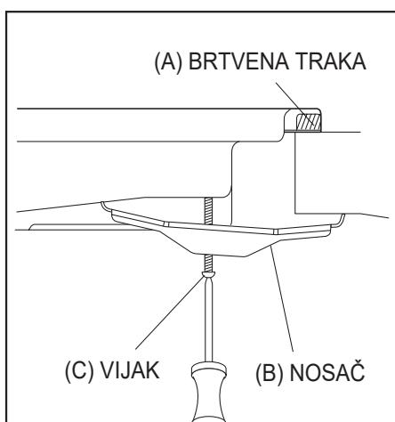
1. Postavite nosač (B) preko otvora vijaka. U svakom kutu ploče nalazi se po jedna grupa otvora vijaka. Malo zategnite vijak (C) na nosaču (B) tako da se nosač spoji na ploču ali i da još možete podešiti njezin položaj.
