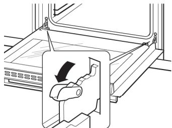
2. Zatvorite vrata otprilike do kuta od  $30^\circ$ . Vrata držite jednom rukom sa svake strane. Podignite i polako izvucite vrata iz pećnice.
