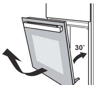
3. Otvorite sklopku držača za rotaciju vrata; videti korak na sledećoj slici.
