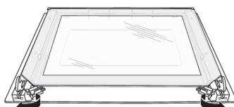
4. Podignite spoljašnje staklo vrata i izvucite ga; nakon toga, izvadite srednje staklo vrata na isti način.
