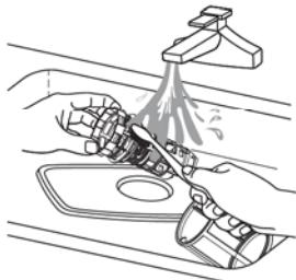
3 Veći ostaci hrane mogu da se očiste pranjem filtera pod tekućom vodom. Za temeljnije čišćenje, koristite mekanu četku za čišćenje.
