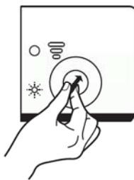
Podesite indikator za sredstvo za ispiranje na željeni broj. Što je veći broj, to će više sredstva za ispiranje mašina koristiti. Ako se posuđe ne osuši pravilno ili ako se na njemu vide flekice od vode, podesite brojčanik na sledeći veći broj sve dok vaše posuđe ne bude bez fleka. Smanjite broj ako na vašem posuđu nalazite lepljive beličaste fleke ili plavkast film na staklenom posuđu ili oštricama noževa.
