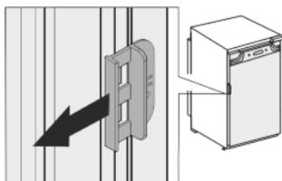
Ako je transportna zaštita vijčano spojena na vrata:
