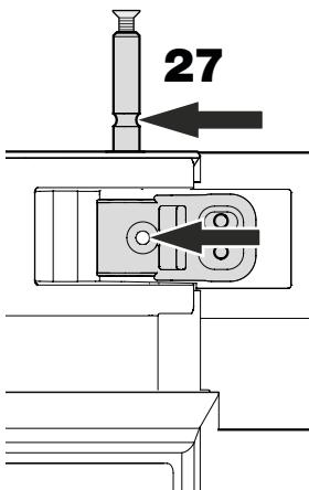
**27.** Utisnite osovinu šarke dok se utor u osovini ne poravnava s otvorom u nosaču šarke.
